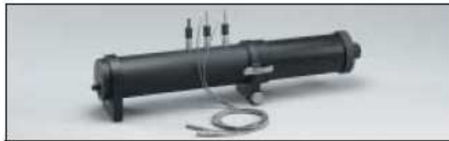
Kuva 6.1. TKK:n Akustiikan ja äänenkäsittelytekniikan laboratorion impedanssiputki [28].
